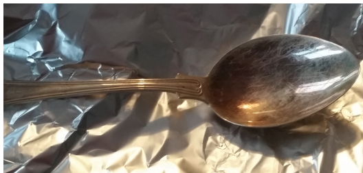
Figur 6.1: En korroderad silversked och aluminiumfolie.
