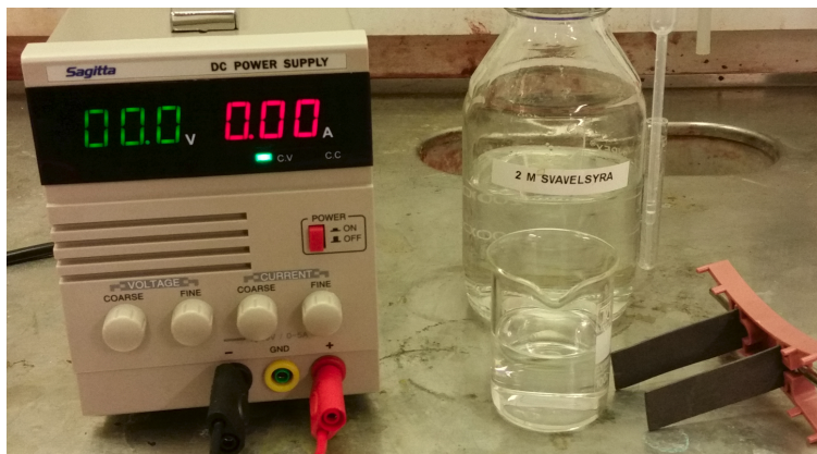
Figur 2.9: Ett enkelt blybatteri på lab, färdigt för att börja laddas.
