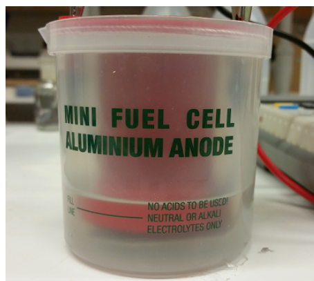
Figur 2.19: En aluminium (bränsle)-cell med katalytisk aktiverat kolkatod för sonderdelning av syrgas.
