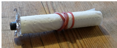
Figur 3.26: En enskild aluminium cell enligt instruktion till Kemins dag 2015
