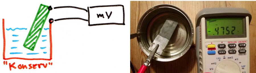
Figur 2.2: Elektrokemisk analys av okänd metall i konservburk. Observera att testmetallen och burken inte får komma i kontakt med varandra, det bör vara elektrolyt mellan dessa. Till höger visas konservburk jämförd med en bit zinkmetall. Konservburken är ansluten till minuspolen och pluspolen till referensen, i det här fallet zink. Den negativa potentialskillnaden antyder att zink ligger 0.475 V under konservburken.
