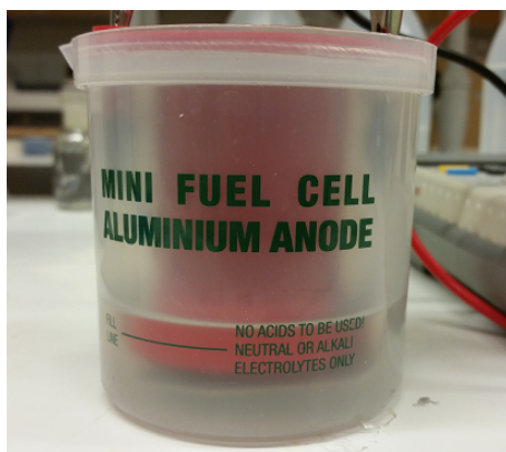
Figur 3.27: En aluminium (bränsle)-cell med katalytisk aktiverat kolkatod för reduktion av syrgas.
