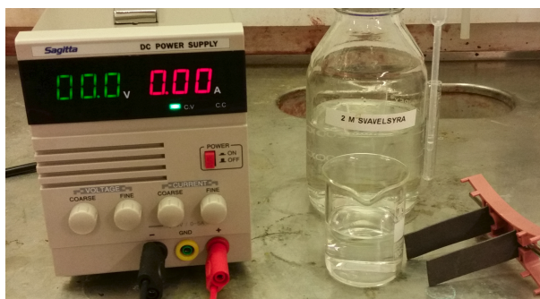
Figur 3.31: Ett enkelt blybatteri på lab, färdigt för att börja laddas. Observera att båda blyelektrodena ser likadana ut från början.
