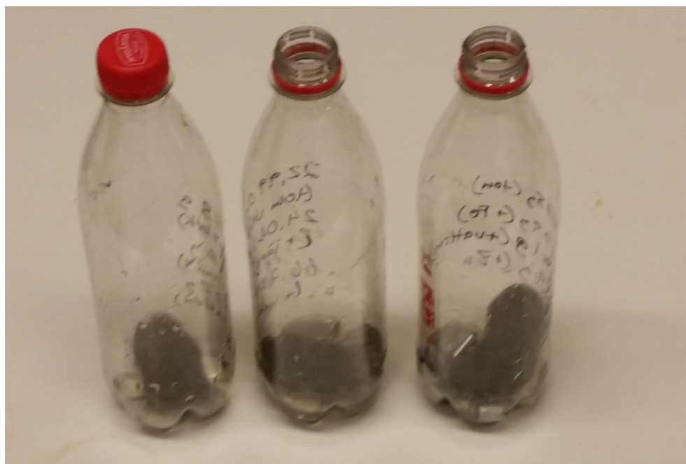
Figur 4.1: Tre petflaskor med järnull, vatten och olika tillgång på syrgas respektive reduktionsmedel. Flaskan längst till vänster har stängd kork, den i mitten fri tillgång till luft samt den till höger innehåller dessutom zinkbitar.
